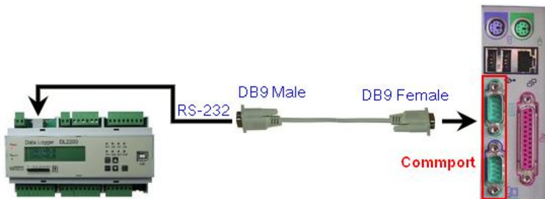
การเชื่อมต่อ DL2200 กับเครื่องคอมพิวเตอร์ผ่านทาง Serial Port
