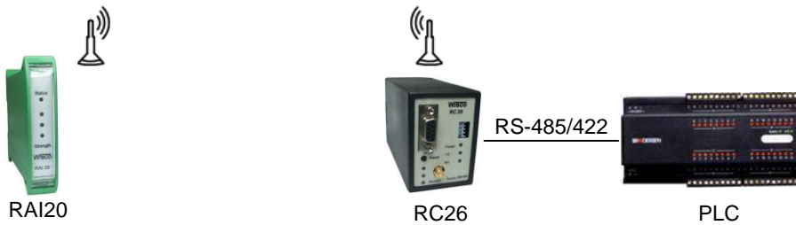
การเชื่อมต่อกับอุปกรณ์ PLC หรือจอ Touch Screen โดยใช้ Protocol Modbus
