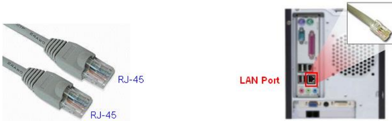
สาย LAN และ LAN Port ของเครื่องคอมพิวเตอร์
